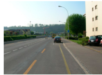
Bande cyclable interrompue par du stationnement juste avant une traversée piétonne
